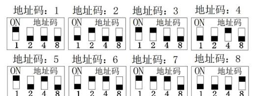
备注: 模块电源DC24V (V+, V-), 电源接入是必须的。数据总线 (T+, T-), 多个模块并接, 接入主机 (T+, T-) 端, 将报警数据传入主机。每个模块都有一个唯一的地址码, 模块接入主机前请设置好地址码, 地址码按8421原则进行编码。
